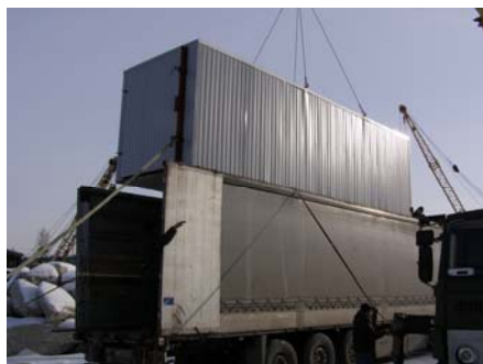
Погрузка сушильной камеры СКМ-10 для перевозки
